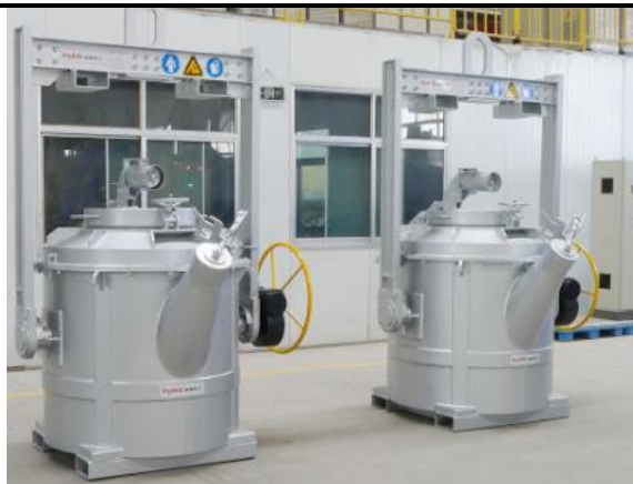
圖 34: 液態鋁合金通過“茶壺狀”容器對外出貨運輸
