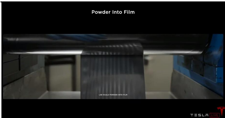
圖 4：幹電極工藝：以節約成本
